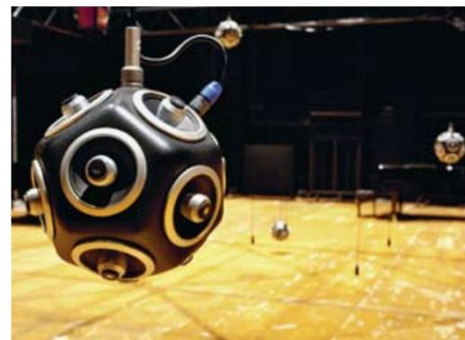
La sala di prova e registrazione, con la struttura metallica regolabile in altezza, cui sono appesi 16 microfoni sferici, ciascuno composto da 12 altoparlanti, regolati in modo da produrre una sfera virtuale di sonorità e ridurre al minimo la "latenza" (ritardo tra la produzione del suono, la risposta della stanza e il momento in cui il suono giunge allo spettatore).
